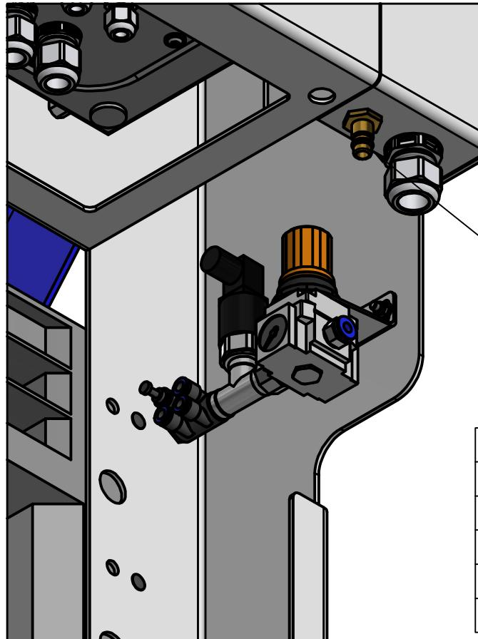
P1 Kupplungsstecker AG 3/8" min. 4bar Druckluft
