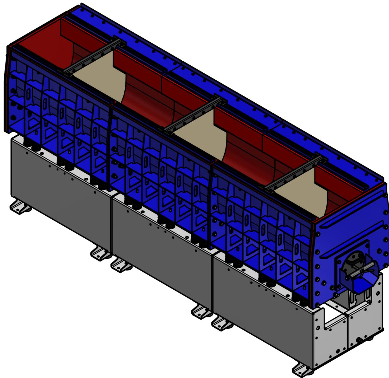
Abrisskante u. Trennwand
